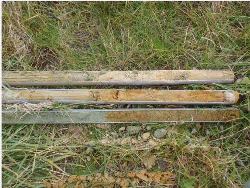
Figure 2 : Déplacement de la sondeuse entre les points de sondages (en haut) et exemples de carottes sous gaine obtenues avec la Géoprobe.
