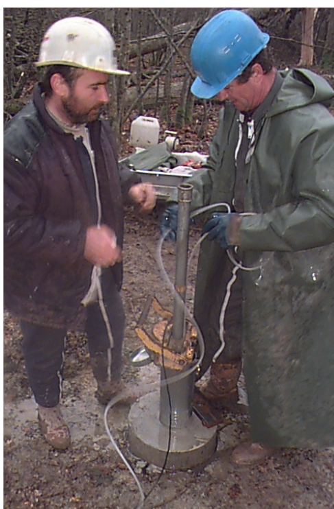
Photo 1 : Descente du train de mesure de "pulse test" dans un forage flûte de Pan
