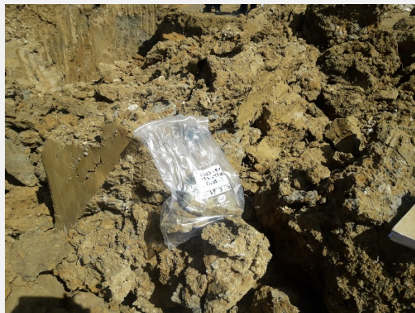
Figure 8 : Faciès de la frange altérée des argiles de l'Aptien inférieur
