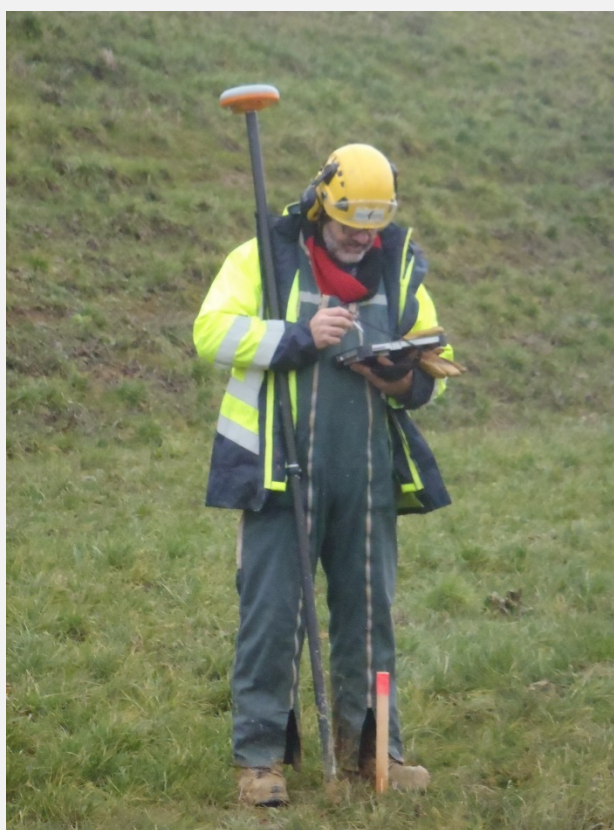
Figure 1 : Implantation des sondages à l'avancement.
